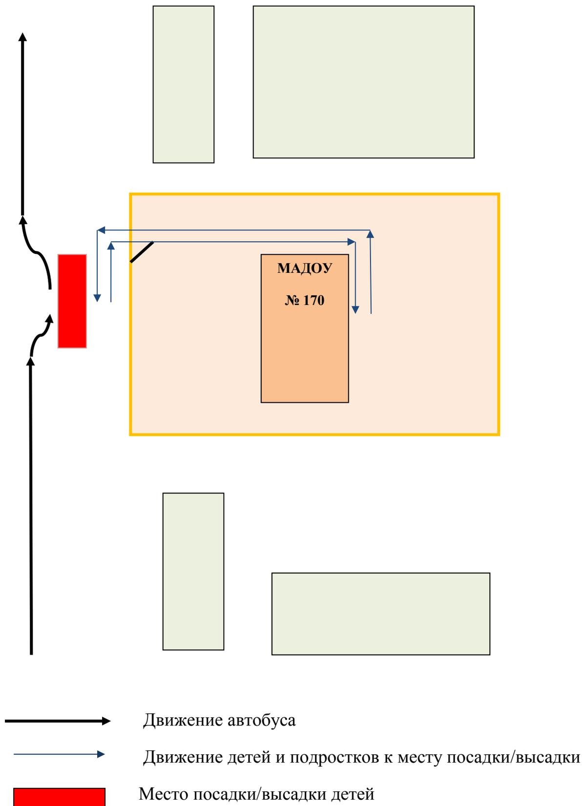
План – схема пути движения транспортных средств и воспитанников при проведении дорожных ремонтно-строительных работ
